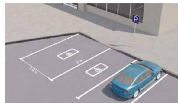
**п.5.2.5.** Встроенные, в том числе подземные, стоянки транспортных средств должны иметь связь с функциональными этажами здания с помощью лифтов, приспособленных для перемещения инвалидов на кресле-коляске с сопровождающим лицом. Параметры специализированного места для стоянки (парковки) транспортных средств инвалидов в зданиях и сооружениях следует принимать по 5.2.4.
